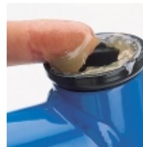
**4** Die Lagerkugeln oder Kugellager in die saubere Lagerinnenschale einlegen und reichlich **FETTEN**. Tip: Beim Einbau loser Kugeln in die untere Lagerschale Bike auf den Kopf stellen, Lagerschale erst fetten und dann die Kugeln ins Fett „kleben“.
