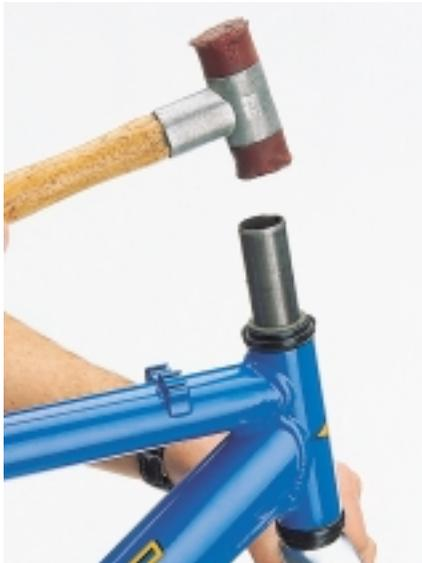
**1** Zum **GABELAUSBAU** die Vorderbremse sowie Lenker und Vorbau demontieren. Obere Lagerschale abnehmen. Sind offene Lager ohne Kugellager verbaut, unbedingt ein Tuch oder eine Auffangschale unter den Steuerkopf halten, damit keine Kugeln verlorengelangen.
